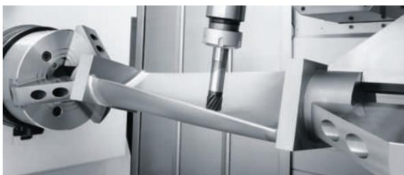
Il mandrino di fresatura, orientabile di 240° in continuo, consente una truciolatura ottimale in qualsiasi posizione e la realizzazione di particolari complessi che richiedono lavorazioni con 5 assi simultanei.
